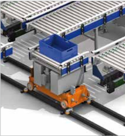
Detalle de carro lanzadera (1).
